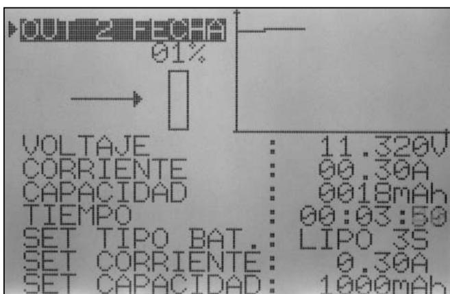
Se ajusta la definición del parámetro de la batería mediante las tres posibilidades de ajuste, tipo de batería, corriente de carga y capacidad.
