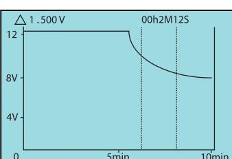
Auch bei diesem Ausgang steht ein Untermenü mit der Spannungsanzeige in Kurvenform zu Verfügung. Dazu Cursor in die zweite Zeile bringen und Enter drücken. Erneuter Drücken von Enter schließt das Fenster.
