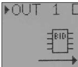
Danach wird das BID Symbol im Display angezeigt. Wenn die Akkuparameter auf dem BID-Chip voreingestellt sind, kann der Lade-
