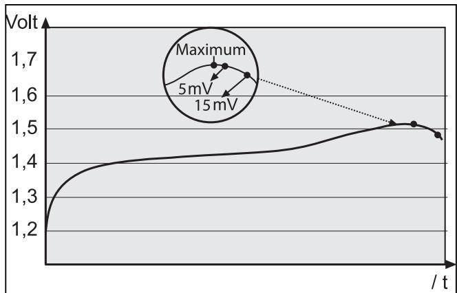
Vorstehende Grafik zeigt eine typische Ladekurve eines NC- NiMH-Akkus. Am Ende des Ladevorgangs verändert sich der Innenwiderstand des Akkus auf Grund der Zellenerwärmung. Dadurch sinkt die Zellenspannung geringfügig ab. Schaltet das Ladegerät exakt auf dem höchsten Punkt der Ladekurve ab, so spricht man von "Zero-Delta-Peak" oder.
