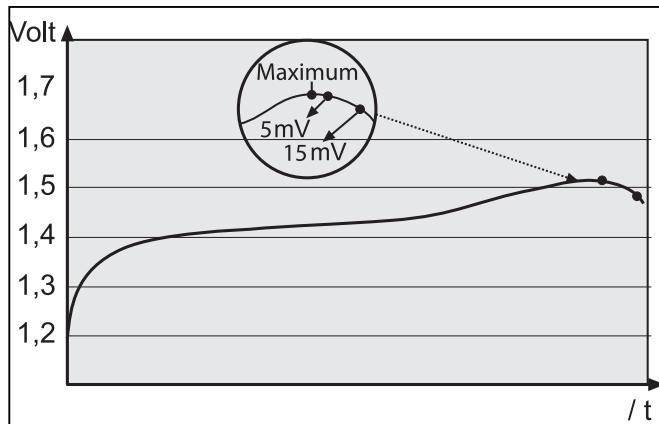
Uvedený graf znázorňuje typickou nabíjecí křivku u NiCd a NiMH akumulátorů. Na konci procesu nabíjení se na základě zahřátí článků změní vnitřní odpor akumulátoru.
