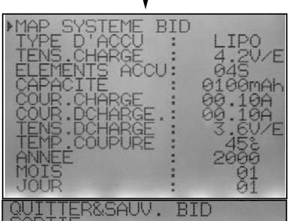
Réglage des paramètres de charge de la puce BID ou de la clé. Uniquement lorsque la puce/clé BID est plantée.
