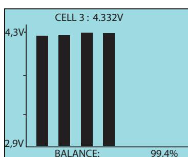
Il est possible alternativement de faire apparaître la tension de chacun des cellules sous forme d'histogramme.
