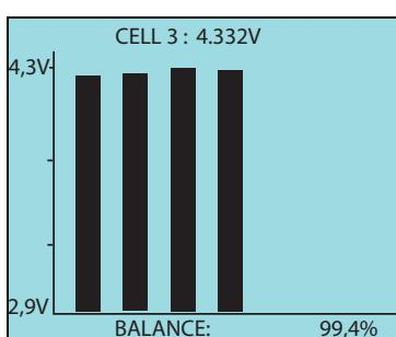
In alternativa è possibile visualizzare le tensioni sul display in forma di diagramma a barre. Per scegliere tale opzione, portare il cursore sulla riga 3 e premere poi il tasto Enter.
