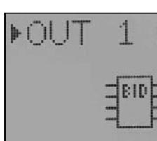
Lorsque la puce BID est en place, apparaît dans le menu "caractéristiques OUT 1" un symbole pour BID. La liste des réglages de l'accu est étendue. Lorsque la puce BID n'est pas formatée (neuve) apparaît un message indiquant une erreur de la mémoire BID et requérant la saisie de caractéristiques BID.
