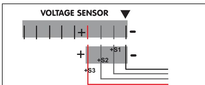
Rappresentazione schematica del corretto collegamento del cavo sensore di voltaggio.
