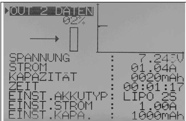
Die Definition der Akkuparameter wird durch die drei Einstellmöglichkeiten, Akkutyp, Ladestrom und Kapazität eingestellt.
