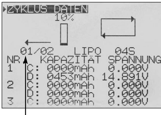
Anzeige des aktuellen Zyklus im Display. In diesem Beispiel läuft gerade der Zyklus 1, von beiden vorgewählten Zyklen.
