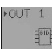
Se un chip BID viene collegato al dispositivo, appare nel menu "OUT 1 DATEN" il simbolo BID e l'elenco delle impostazioni si allunga. Se il Chip non risulta essere formattato (chip nuovo), compare una notifica sul display che indica che è necessario immettere i parametri all'interno del chip (configurazione del chip).
