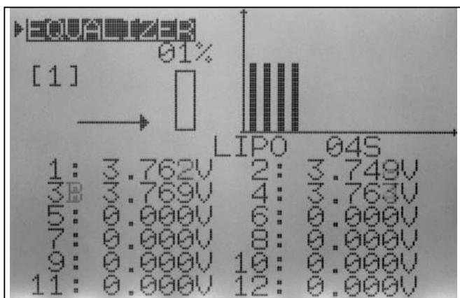
**Es imprescindible conectar también el cable de carga de la batería (positivo + negativo) con el aparato, para alcanzar los mismos potenciales para una medición precisa de la tensión de los elementos.**
