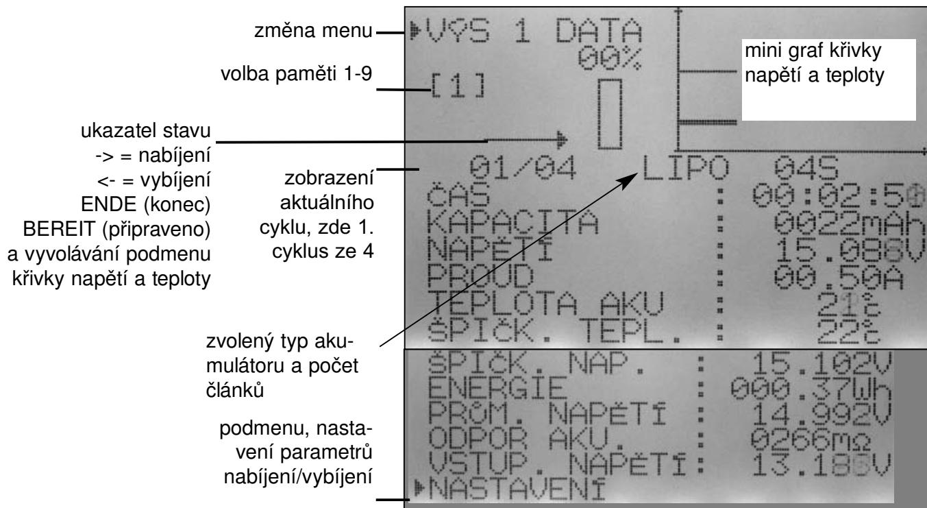
Nabíječ disponuje 9 interními paměťovými pozicemi [1]...[9], do kterých lze předprogramovat parametry pro nabíjení a vybíjení. Všech 9 pamětí lze odlišně konfigurovat.
