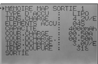
Réglage des paramètres de charge de l'emplacement de mémorisation 1 à 9
