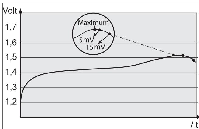
Il grafico illustra il tipico andamento di una curva di ricarica delle batterie NC - NiMH. E' possibile notare come al termine della procedura si generi un cambiamento nella resistenza interna della batteria, causato dal riscaldamento delle celle. Tale fenomeno comporta una lieve riduzione nella tensione delle celle.
