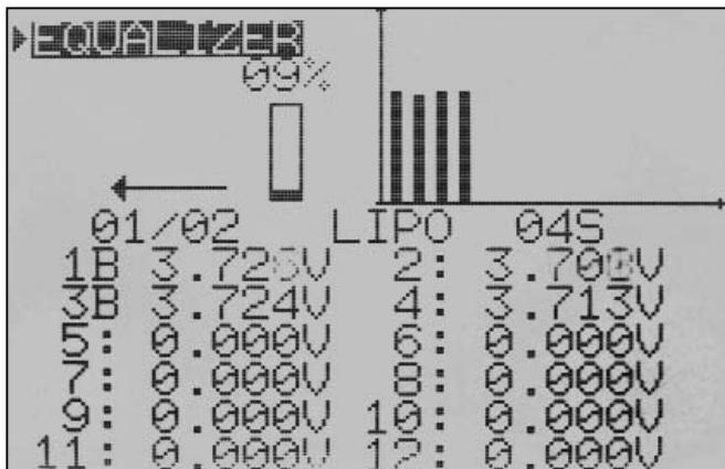
**Es muss unbedingt auch das Akkuladekabel (plus + minus) mit dem Gerät verbunden werden, um gleiche Potentiale für eine präzise Zellenspannungsmessung zu erreichen.**
