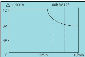
À cette sortie également on dispose d'un sous-menu avec affichage de la tension sous forme de courbe. Pour ce faire, amenez le curseur dans la seconde ligne et actionnez Enter. Une nouvelle pression sur Enter permet de fermer la fenêtre.
