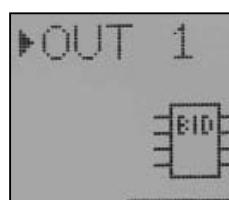
en el menú "Datos OUT 1" el símbolo BID. Se amplia la lista de ajustes de la batería. Si el BID-Chip no está formateado (nuevo), aparece el aviso error en la memoria del BID. Entonces entrar datos al BID.
