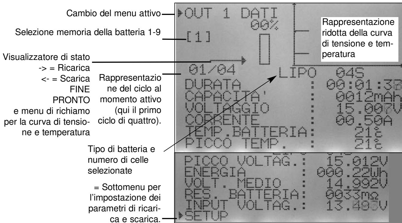
Il caricabatterie dispone di 9 memorie interne per batterie [1] ... [9] che possono essere pre-impostate con i parametri corretti di ricarica e scarica. Ciascuna di esse è configurabile separatamente. Tale soluzione permette di avviare rapidamente una procedura di ricarica per le tipologie di batterie più comuni, richiamando semplicemente i parametri impostati e memorizzati.
