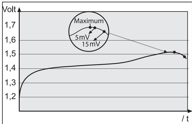
Este gráfico muestra una curva de carga típica de una batería NiCad/NiMH. Al final del proceso de carga, se modifica la resistencia interior de la batería a causa del calentamiento de los elementos. Por esto, la tensión de los elementos baja ligeramente. Cuando el cargador desconecta exactamente en el punto máximo de la curva de carga, entonces de habla de “Zero-Delta-Peak”.
