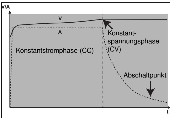
In dieser Phase stellt der Lader sicher, dass der eingestellte Ladestrom konstant bleibt.
