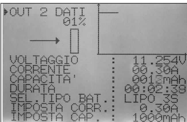
Per definire i parametri della ricarica è sufficiente impostare le voci: tipo di batteria, corrente di ricarica e capacità. Questa uscita non consente la ricarica, la scarica o il bilanciamento di batterie Litio!
