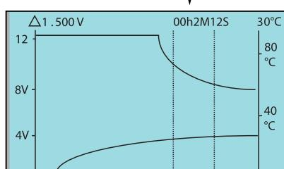
Indicación de curvas de tensión y temperatura en el submenú.
