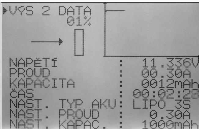
Určení parametrů akumulátoru je nastavována pomocí 3 možností nastavení - podle typu akumulátorů, nabíjecího proudu a kapacity.
