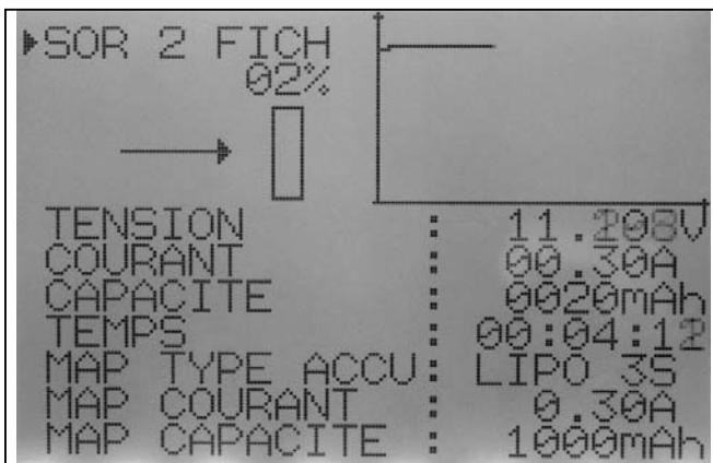
La définition des paramètres de l'accu est établie à l'aide des trois possibilités de mise au point : type d'accu, courant de charge et capacité.
