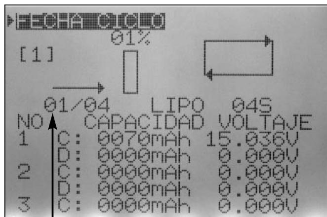
Indicación del ciclo actual en el display. Muestra el ejemplo del ciclo 1 de los dos ciclos preseleccionados.
