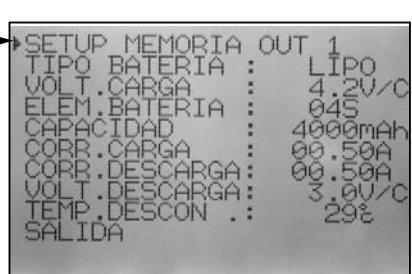
Ajuste de los parámetros de carga para la memoria de la batería 1...9
