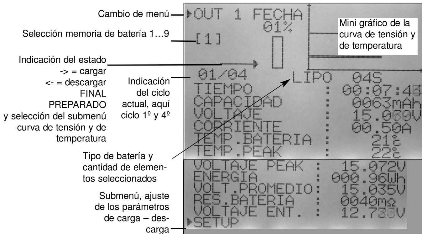
El cargador dispone de 9 memorias internas (1)...(9), los cuales pueden preajustarse mediante parámetros de carga y descarga. Se pueden configurar las 9 memorias de la batería de diferentes maneras.
