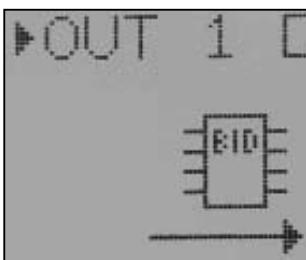
Poté se zobrazí na displeji symbol BID. Pokud jsou parametry předprogramovány na BID čipu, lze proces nabíjení/vybíjení spustit
