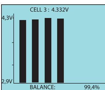
Alternativ kann die Einzelzellenspannung in einer Balkengrafik dargestellt werden.
