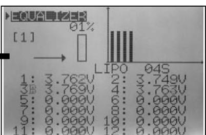
El menú ecualizador aparece solamente, cuando hay una batería de litio seleccionada y el cable del sensor conectado.
