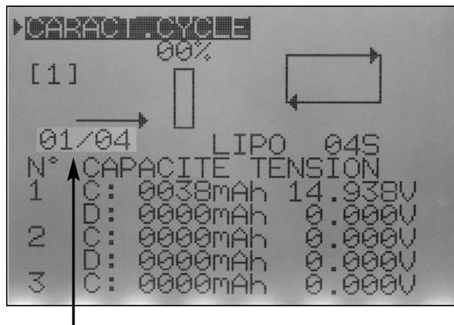
Affichage du cycle actuel sur l'écran. Dans cet exemple se déroule justement le cycle 1 des deux cycles présélectionnés.
