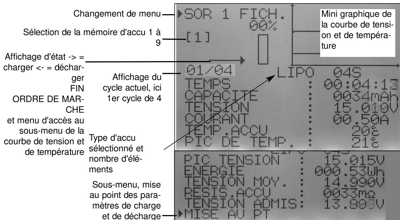
Le chargeur est muni de 9 emplacements de mémoire interne d'accu [1] à [9] qu'il est possible de programmer avec des paramètres de charge-décharge. Il est possible de configurer différemment les 9 emplacements de mémoire d'accu.
