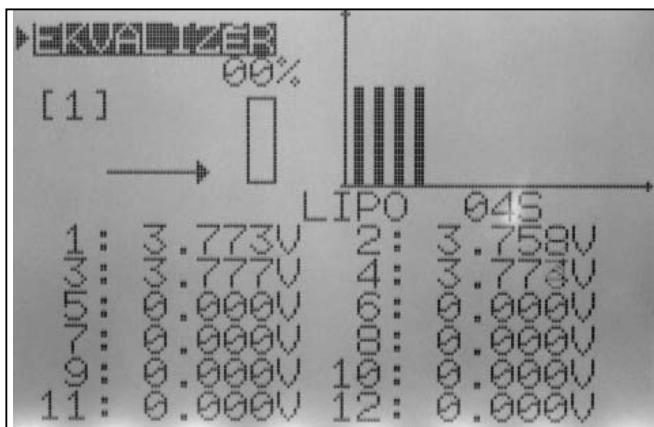
**Aby bylo dosaženo precizního měření napětí článků, je bezpodmínečně nutné připojit k nabíječi i nabíjecí kabel akumulátorů (plus + minus).**
