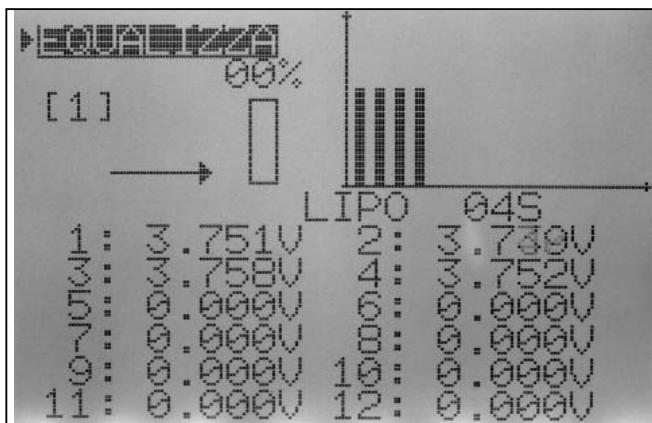
Risulta comunque necessario collegare anche i cavi della batteria al caricatore (polo + e polo -) per ottenere un bilanciamento delle celle preciso e ottimale.
