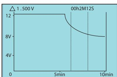
Kurvenanzeige der Spannung im Untermenü
