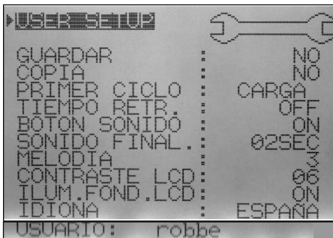
Esta función sirve para memorizar datos de la batería durante los procesos de carga y descarga.
