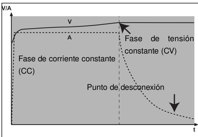
En esta fase, el cargador asegura que la corriente de carga ajustada quede constante.
