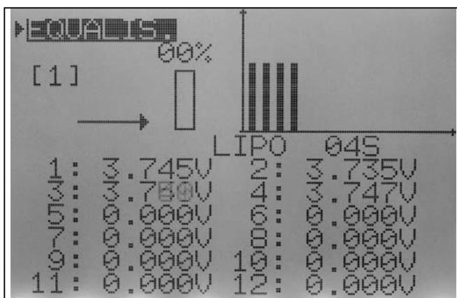
**Il faut impérativement que le cordon de charge de l'accu (plus + moins) soit raccordé au chargeur pour obtenir les mêmes potentiels pour une mesure précise de la tension des éléments.**
