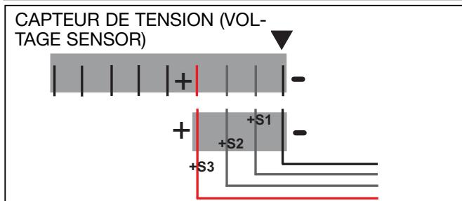
Représentation schématique de l'affectation du cordon de raccordement du capteur de tension.
