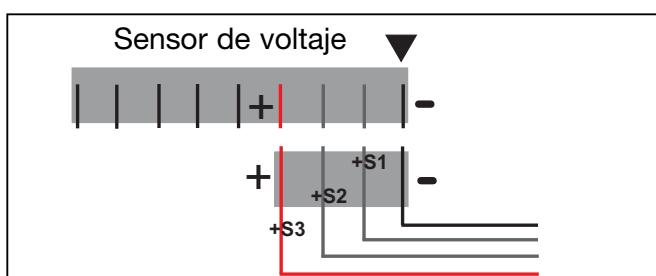
Representación esquemática de la asignación del cable de conexión del sensor de voltaje.
