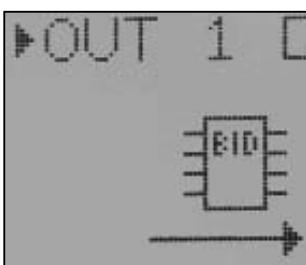
Compare quindi sul display il simbolo BID, come visualizzato nell'immagine. Se i parametri della batteria sono memorizzati nel chip, è possibile
