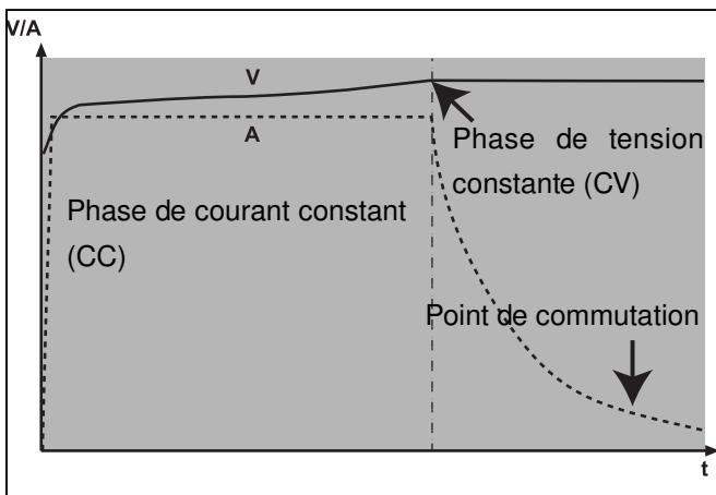
Dans cette phase le chargeur s'assure que le courant de charge établi reste constant. Avec un courant de charge de 1C et un accu déchargé, cette phase dure environ 50 à 60 minutes. Elle charge une capacité d'accu de 80 à 90 % environ.
