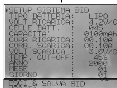
Impostazione dei parametri di ricarica per Chip o chiavetta BID. Attivo soltanto se il dispositivo BID è collegato.
