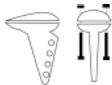
**Montieren Sie den Plastik Ruderhorn mit dem Hebel an der Unterseite mit Hilfe der M2-Kupferschrauben und -muttern auf die linken Höhenruderfläche.**
