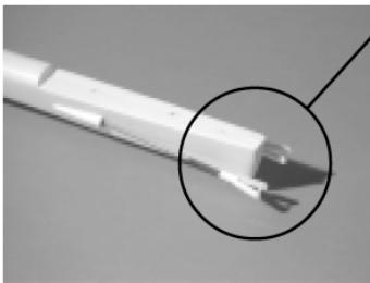
Schroef de plastiek kwiklinks op de metalen stuurstangen om te vermijden dat de stuurstangen uit de romp glijden.
