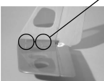
Monteer het kielvlak op het hoogteroer door de 2 metalen pennen door het hoogteroervlak te steken. Steek vervolgens de metalen pennen door de plastiek romp en borg ze aan de onderzijde met 2x M2 moeren.
