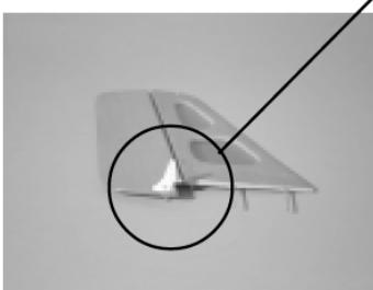
Monteer de plastiek roerhoorn door middel van de koperen M2 schroeven en moeren op het kielvlak met de hefboom aan de rechterzijde.
