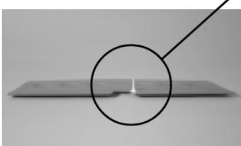
Monteer de plastiek roerhoorn door middel van de koperen M2 schroeven en moeren op het linkse hoogteroervlak met de hefboom aan de onderzijde.
