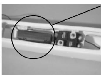
Sluit de servo's en snelheidsregelaar aan op de ontvanger en plaats de ontvanger achter de servo's.
