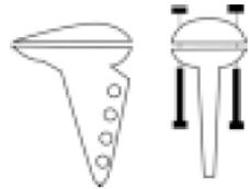
**Montieren Sie den Plastik Ruderhorn mit dem Hebel an der rechte Seite mit Hilfe der M2-Kupferschrauben und -Muttern auf die Seitenruder flache.**
