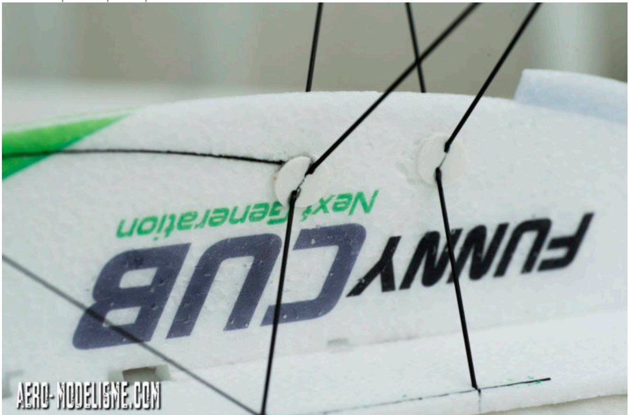
Les jambres de trains finies avec les pièces plastiques du corps central
