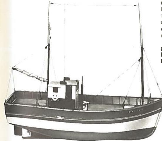
**CHALUTIER DE BOULOGNE**. Chalutier 17 m. Ce type de bateau se trouve dans tous nos ports de pêche. Le modèle présenté est typiquement BOULONNAIS. Grandeur d'exécution, échelle 1/25, longueur 670 mm, largeur 215 mm, hauteur totale avec mâts 560 mm. Blocs avant et arrière façonnés et tout le matériel bois pour la construction du modèle navigant. La boîte avec plan ..... F 131,00
