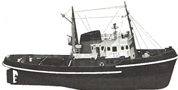
« **REMORQUEUR de haute mer** », série ABELLE, grandeur réelle 38,50 m, largeur 9,10 m. Tirant d'eau 4,50 m, puissance 1 800 CV, vitesse 13,42 nœuds, effort traction 24,5 tonnes. Grandeur d'exécution au 1/40, longueur 980 mm, largeur 230 mm. Cette maquette peut être propulsée, VAPEUR, ÉLECTRIQUE, et équipée de la radiocommande, blocs AV et AR terminés, couples, ponts, quille et baguettes, surperstructures découpées. La boîte avec plan détaillé ..... F 275,50
