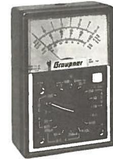
**MULTIMETER :** Compte-tours électronique combiné avec l'appareil de mesure universel. Gamme de mesure : 0 à 7 000 t/mn, 0 à 14 000 t/mn, 0 à 25 000 t/mn.
