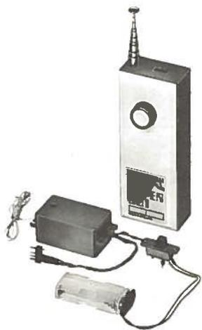
**Ensemble monocanal G52 Emetteur** piloté par quartz sur 27 MHz, alimentation 9 volts, consommation 45 MA, modulation 900 MHz, puissance 250 M.W., dimensions 140 x 55 x 40 mm.
