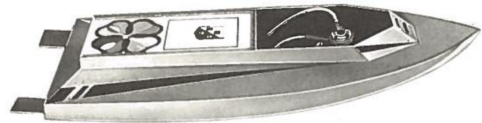
**MINI DELPHIN :** Bateau de vitesse destiné à la compétition, pour moteur à explosion. Boîte de construction comprenant : coque moulée en Epoxy, pont et superstructure en contreplaqué prédécoupé. Pièces d'accastillage livrées dans une boîte séparée comprenant le support du moteur en métal moulé, l'arbre d'hélice, la prise de pression, le gouvernail en laiton. Longueur, 700 mm pour moteur marin de 5 cc à 7,5 cc, la boîte .....
