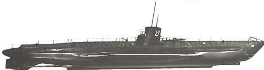
**SOUS-MARIN** de la Série U 27 à 36. Echelle 1/50, longueur 1,25 m. Cette maquette navigante et plongeante peut être facilement radio-commandée. Boîte comprenant blocs avant et arrière, la quille, les couples, les baguettes, petites pièces en bois découpées, le plan en deux feuilles et notice de construction.
