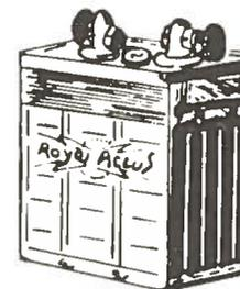
**Accus « ROYAL ACCUS »,** 2 volts, 4 ampères en 20 heures, bac plastique, largeur 55 mm, hauteur 75 mm, épaisseur 35 mm, poids 310 g, la multiplication permet d'obtenir la tension désirée tout en permettant le logement et l'échange le plus facile ..... F 31,25
