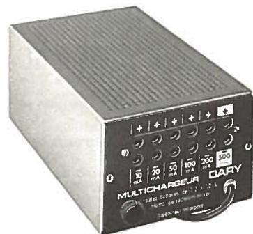
**DARY** Multichargeur moerne garanti 3 ans. Recharge toutes batteries cadmium, nickel et plomb de 1,2 volt à 12 volts de 100 mAh à 10 aH. Débit stabilisé par transformateur à flux dispersé - 6 prises polarisées : 20 mA 2 x 50 mA - 100 mA - 200 mA utilisables simultanément et 500 mA. Voyant de contrôle. Disjoncteur à réenclenchement automatique 220 volts ..... F 113,00
