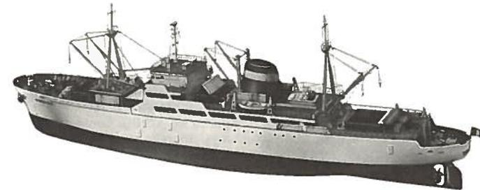
**TARPON**. Transport de fruits, viandes, citerne à vin, échelle 1/81, longueur 1,42 m, largeur 200 mm, hauteur de la coque 150 mm, hauteur totale avec mâts 445 mm. Cette maquette peut être très facilement radiocommandée. La boîte comprend tout le bois, blocs avant et arrière terminés, couples découpés, ponts, quille et baguettes.
