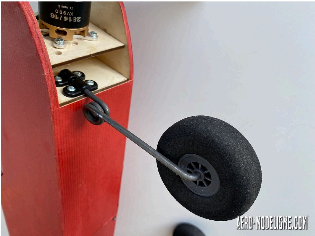
Détail du train avant monté. Très classique.
