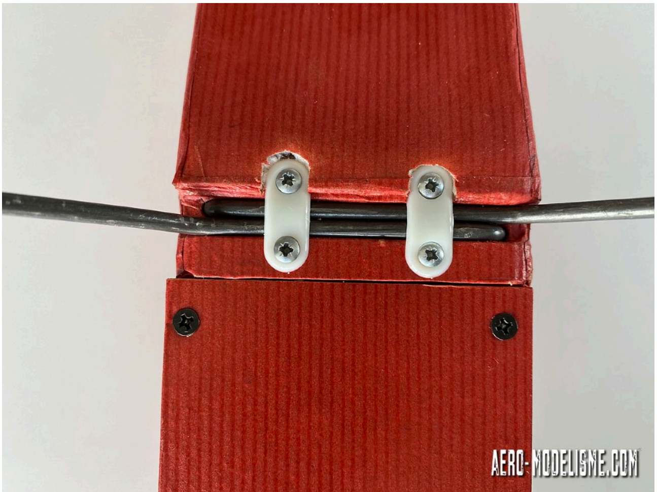
Détaille du montage du train arrière. Très classique aussi.
