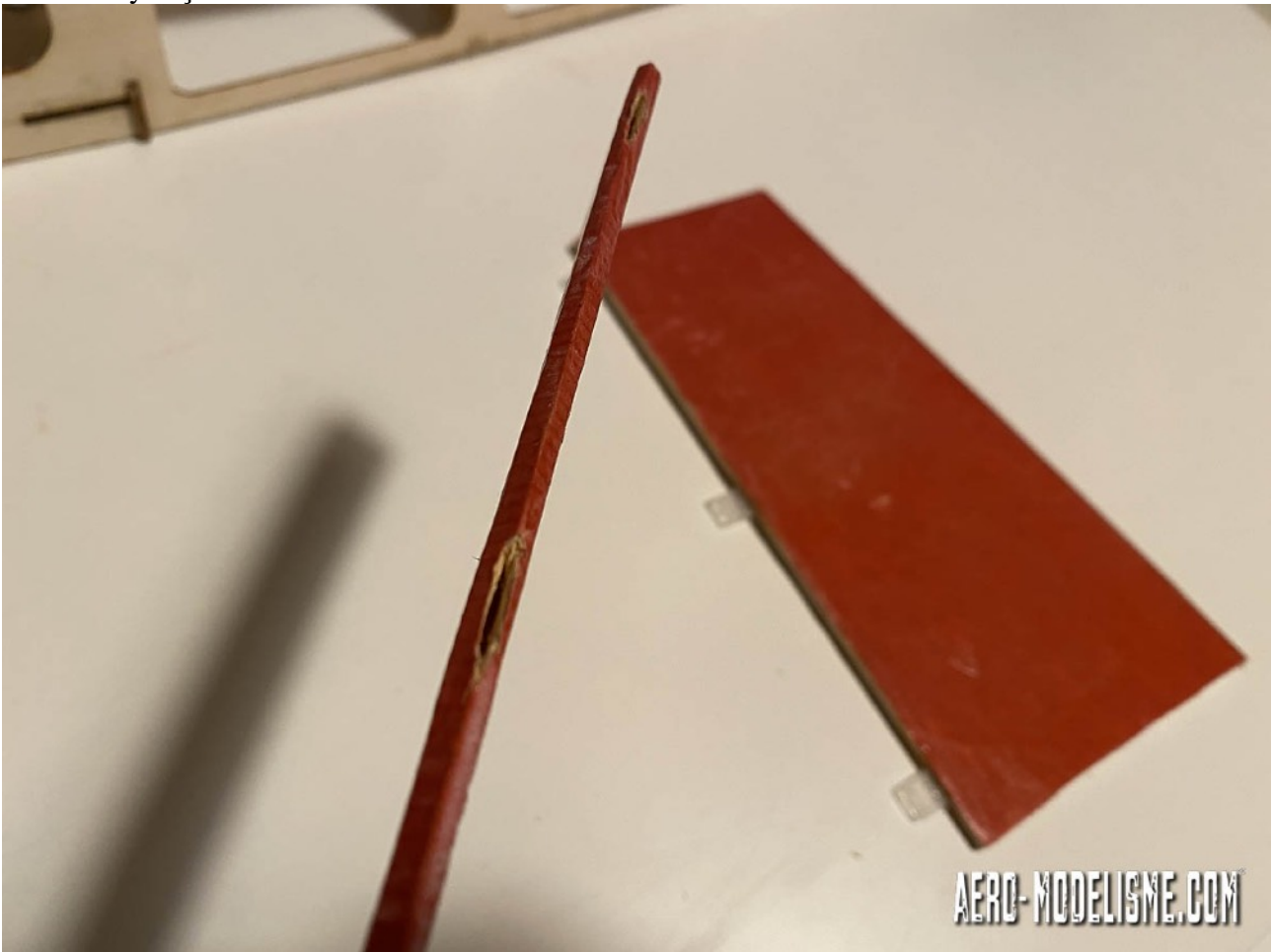
Fentes réalisées de manière fastidieuse au cuttter.
