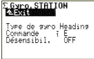
Pour l'utilisation d'un gyroscope en mode Heading (verrouillage de cap) avec possibilité de réglage de la sensibilité avec le curseur E, tout est donc préparé.
