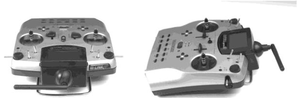
Pour les utilisations où votre modèle ne se trouve pas directement au-dessus ou en dessous de votre émetteur (surtout dans le cas des voitures et des bateaux), la position optimale de votre antenne d'émission est à la vertical vers le haut.
