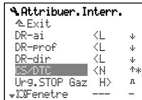
DTC signifie Direc Throttle Control (Direct-Gaz) et n'est utilisé que sur hélicoptères!!
