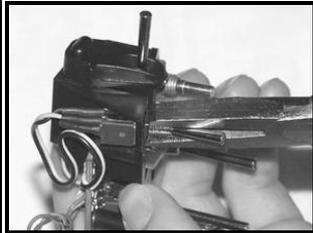
d.) Sortez par pression le bouchon de décoration du boîtier de la radiocommande à l'aide d'un petit tournevis.
