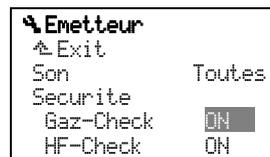
En sortie d'usine celui-ci est sur ON. Les conditions pour la fonction Gaz-Check sont différentes pour les modèles à aile et les hélicoptères et de ce fait traité séparément dans les chapitres suivants.
