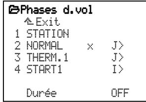
**19.4.4. Réglage du temps de passage d'une phase à l'autre**
